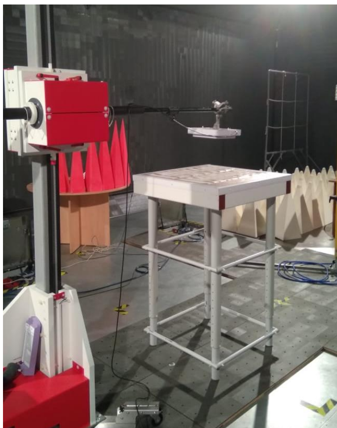
Рисунок 12. Расположение антенны считывателя относительно меток для определения массива с учетом нелицензируемого уровня мощности ГКРЧ.
